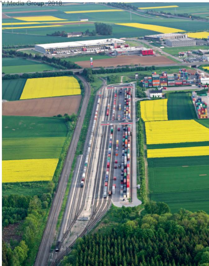
**BILD 3:** Umschlagbahnhof Ulm Nord von 2005 – Beispiel für eine Anlage ohne Durchfahrmöglichkeit im Ladebereich
